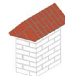
Pokrycie muru w formie dachu dwuspadowego.
